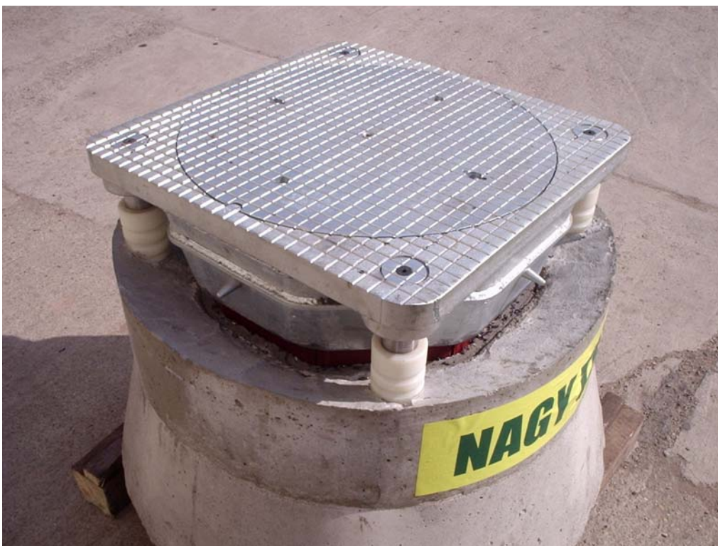
2. ábra. A környezetbarát szintezhető csatornaszem fényképfelvétele
