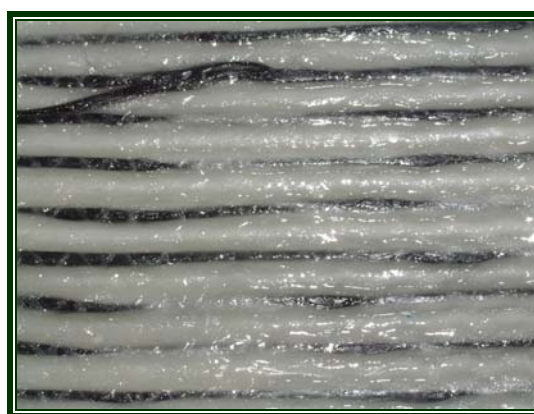
6/a.-6/b. ábra: A grafitsszállal kevert üvegszövet elektromos fűtésével a kompozit műgyanta térhálósodása, leválása 6-8-szor gyorsabb
