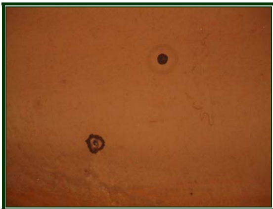
11/a.-11/b. ábra: Tipikus hibahelyek szimplafalú szénacél tartályok falán
