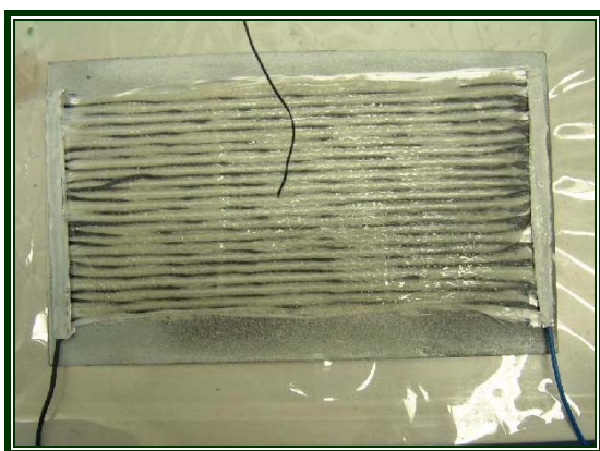
6/a.-6/b. ábra: A grafitsszállal kevert üvegszövet elektromos fűtésével a kompozit műgyanta térhálósodása, leválása 6-8-szor gyorsabb
