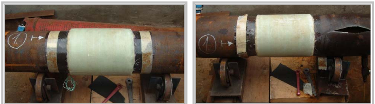
6.ábra NA 200 mm bandázzsal megerősített cső a repesztéses nyomáspróba előtt-, és után.
