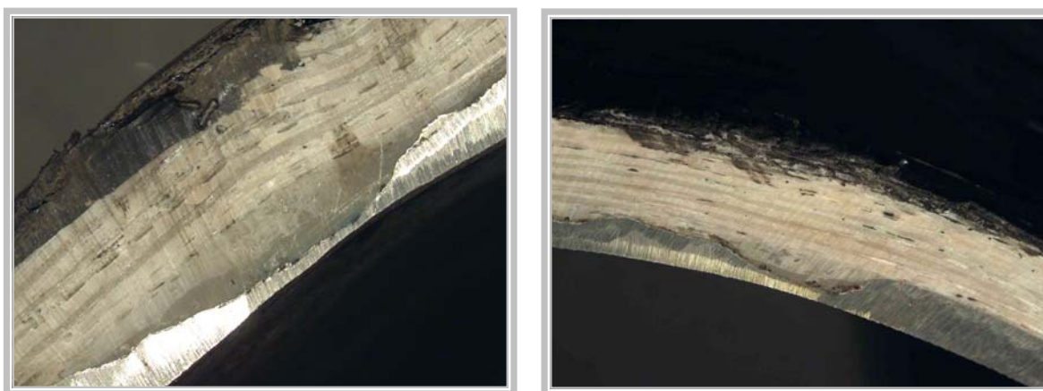
7. ábra Kompozit csőjavító bandázs metszeti képe 91 %, illetve 89 % falvastagság-hiányos acélcsöveken.
