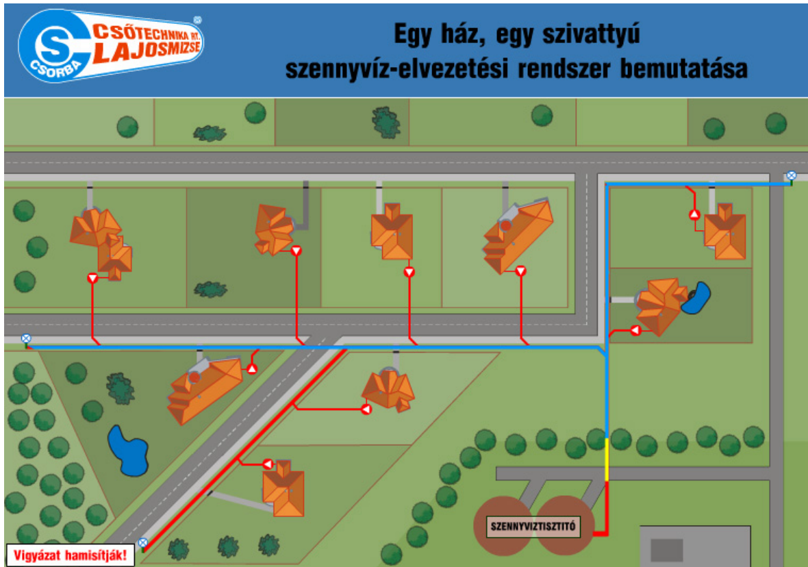
A légbeszívó és az utcai szennyvízhálózatba való bekapcsolódás bemutatása
